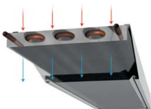
Figura 1. Trave fredda passiva con batteria a lamelle
