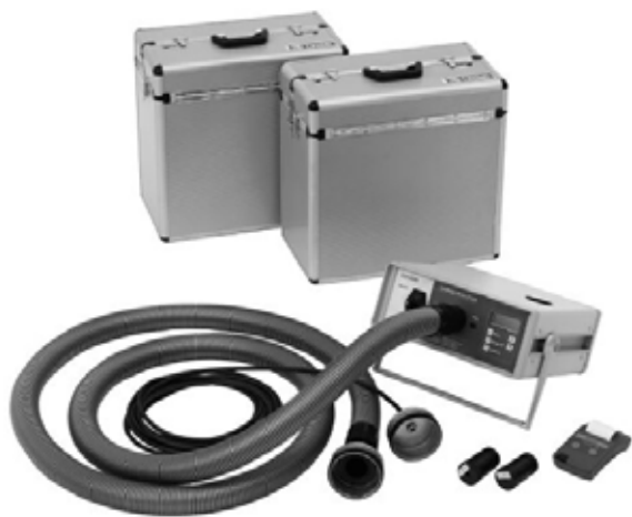
Figura 7. Strumento di misurazione del trafileamento dei canali LT510.
