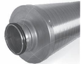
Telefonieschalldämpfer aus Aluminium. Mit Safe-Anschlüssen. Schallschluckpackung aus Mineralwolle, frei von potenziell allergieauslösendem Formaldehyd, Phenol und Acryl. Ohne künstliche Farben, Bleich- oder Färbemittel gebunden. Nicht brennbar gemäß EN 13501-A1. 50 mm dicke Schallisolierung. Unter Verwendung von Knauf Insulation-Mineralwolle mit ECOSE® Technology, ausgezeichnet mit „Der blaue Engel“ und Eurofins Indoor Air Comfort-Gold. Sonderlängen auf Anfrage.
