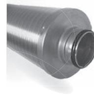
Telefonieschalldämpfer aus Aluminium. Mit Safe-Anschlüssen. Schallschluckpackung aus Mineralwolle, frei von potenziell allergieauslösendem Formaldehyd, Phenol und Acryl. Ohne künstliche Farben, Bleich- oder Färbemittel gebunden. Nicht brennbar gemäß EN 13501-A1. 50 mm dicke Schallsisolierung. Unter Verwendung von Knauf Insulation-Mineralwolle mit ECOSE® Technology, ausgezeichnet mit „Der blaue Engel“ und Eurofins Indoor Air Comfort-Gold. Sonderlängen auf Anfrage.
