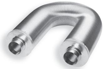
Telefonieschalldämpfer aus Aluminium ohne Lippendichtung. Schallschluckpackung aus Mineralwolle, nicht brennbar gemäß EN 13501-A1. SLF-A25: 25 mm Schallisolierung.
