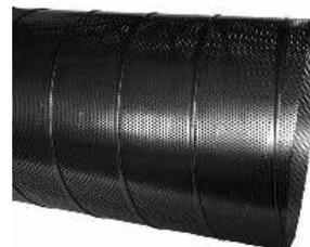
**SRPERF:** Perforiertes Wickelfalzrohr mit Außenfalz aus sendzimirverzinktem Stahlblech, freier Querschnitt 33%. Standardlänge 2,4 m, max. Länge 3 m.
