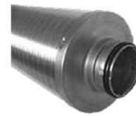
Telefonieschalldämpfer aus Aluminium. Mit Safe-Anschlüssen. Schallschluckpackung aus Mineralwolle, frei von potenziell allergieauslösendem Formaldehyd, Phenol und Acryl. Ohne künstliche Farben, Bleich- oder Färbemittel gebunden. Nicht brennbar gemäß EN 13501-A1. 50 mm dicke Schallsisolierung. Unter Verwendung von Knauf Insulation-Mineralwolle mit ECOSE® Technology, ausgezeichnet mit „Der blaue Engel“ und Eurofins Indoor Air Comfort-Gold. Sonderlängen auf Anfrage.
