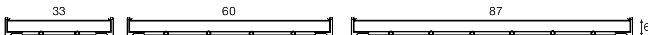
Figur 5. Atrium och Loggia, tillverkas som standard i tre bredder 33, 60*, 87 cm och en höjd 6 cm. Verkligt breddmått är -8 mm.
