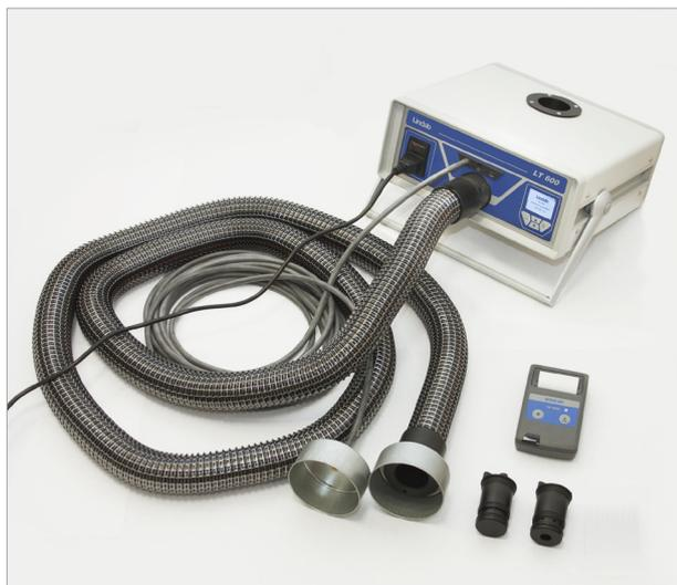
LT600 è un equipaggiamento semplice e compatto per la misurazione in sito delle fughe d'aria degli impianti aeraulici. Tutto contenuto in un kit, compatto e portatile.
