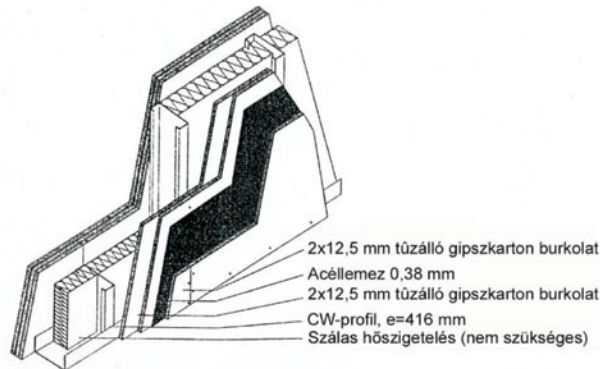
19. ábra. Tűzfal kialakítása könnyű acélszerkezetű épületnél
