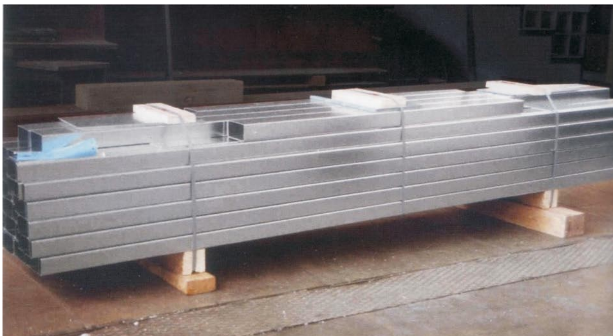
Rakományok tárolása enyhe lejtés biztosításával
