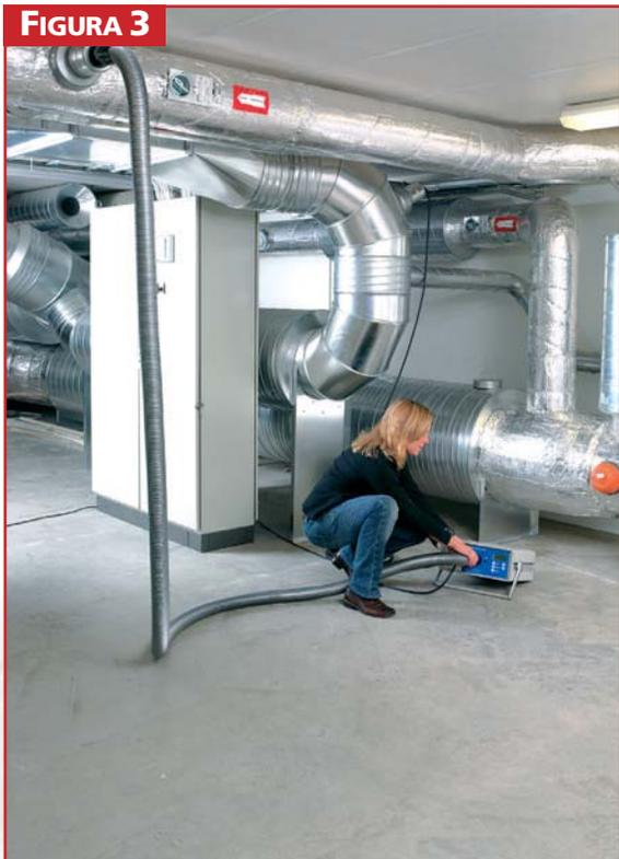
lore delle perdite deve essere registrato, secondo la EN 12237 e la prEN 1507, mantenendo la pressione di test costante con uno scarto di  $\pm 5\%$  rispetto il valore specificato, per un tempo pari a 5 minuti. Questa operazione è normalmente eseguita in modo automatico dal misuratore di fughe d'aria
