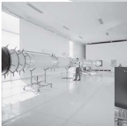
Højttalerrummet (1) og efterklangsrum (4) er forbundet med en 21 meter lang målekanal (2) hvori testobjekterne (3) placeres. Målekanalens dimensioner kan tilpasses testobjekterne, såvel cirkulære som rektangulære.
