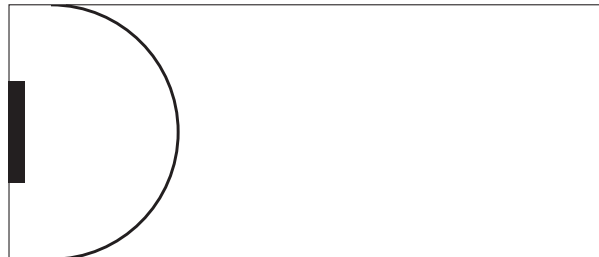
21. ábra, Az egyetlen befúvón bejövő túl nagy térfogatáram túl nagy közelségi zónát eredményez.
