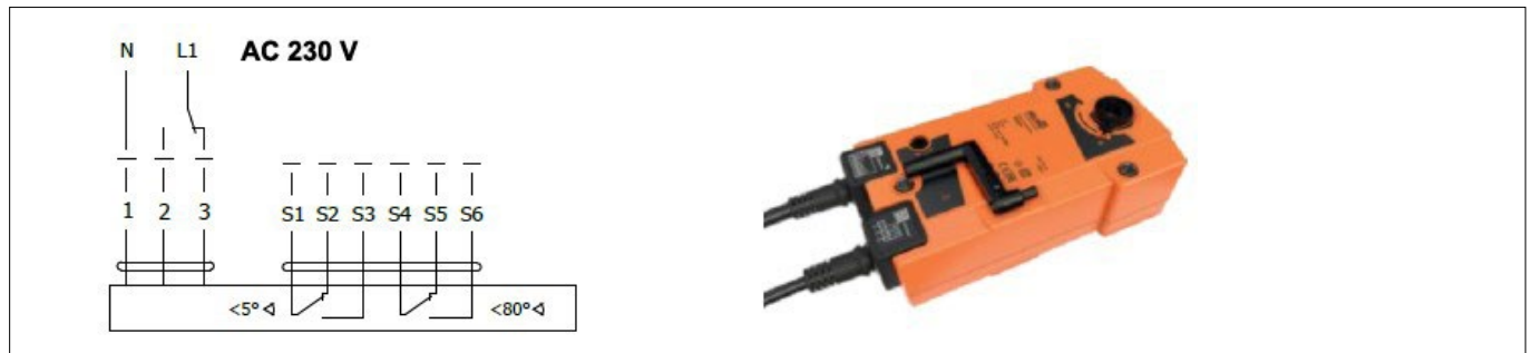
Fig. 8 Actuator BELIMO BEE 230
