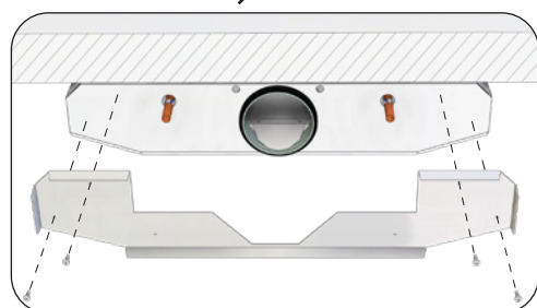
Självborrande skruvar för fästa gavel på baffel. Skruvar (x4) ingår.
