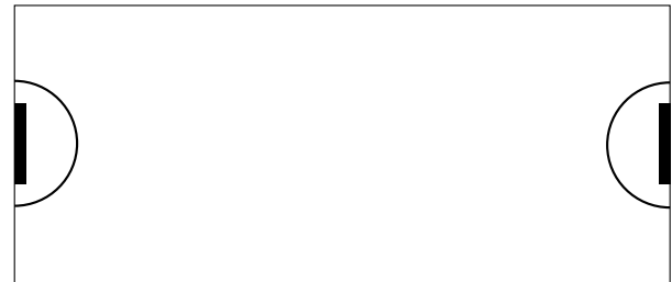
Abb. 10: geringer Volumenstrom pro Auslass, kleiner Nahbereich
