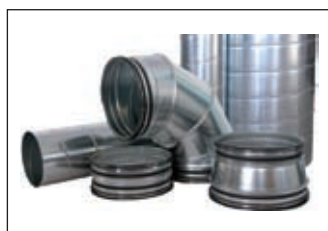
Bild 7: Entrauchungsleitungskomponenten in runder Ausführung mit doppelter Dichtung für Normalbetrieb (Dichtheitsklasse D) und für den Brandfall.
