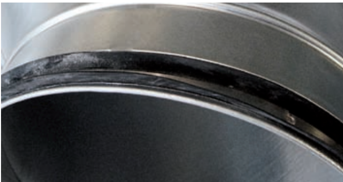
Bild 1: Formstück mit Doppellippendichtung, geeignet für die Errichtung von Luftleitungssystemen mit Dichtheitsklasse D ohne Schraubbefestigung (System Lindab-Click).
