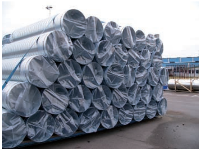
Bild 2: Option - Verschlussene Bauteilöffnungen ab Werk
