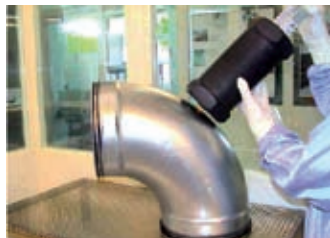
Bild 5: Reinheitsuntersuchung an werkseitig gereinigten Bauteilen im Rahmen einer Produktentwicklung
