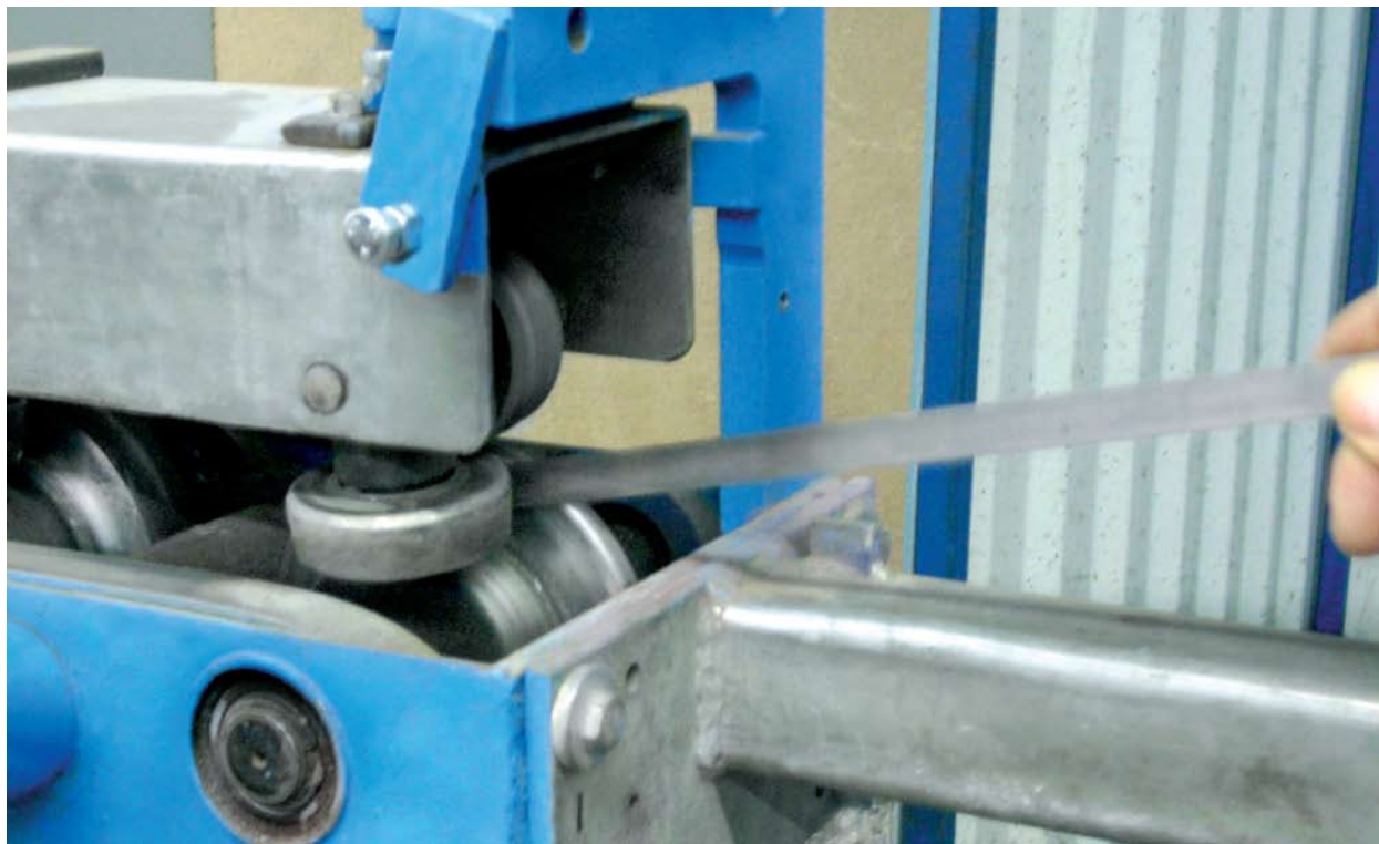
A foton látható görgők közti hézagot igen kell beállítani! Ez ugyanis erősen befolyásolja a hajlítások minőségét.
