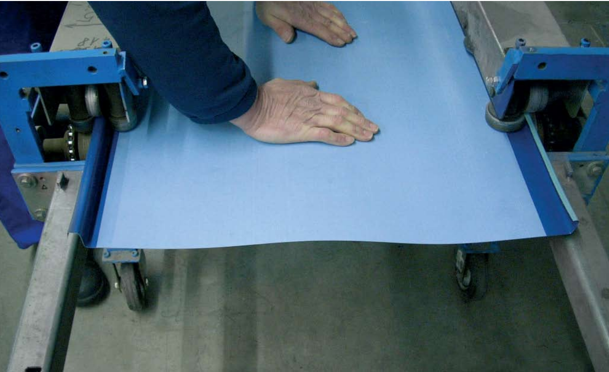
A lemezeket kíméletesen kell tolni a korcolás előtti eljárás alatt, mert máskülönben kidudorodások keletkezhetnek a lemezek közepén, ha csak a görgők kerülnek kontaktusba az anyaggal.
