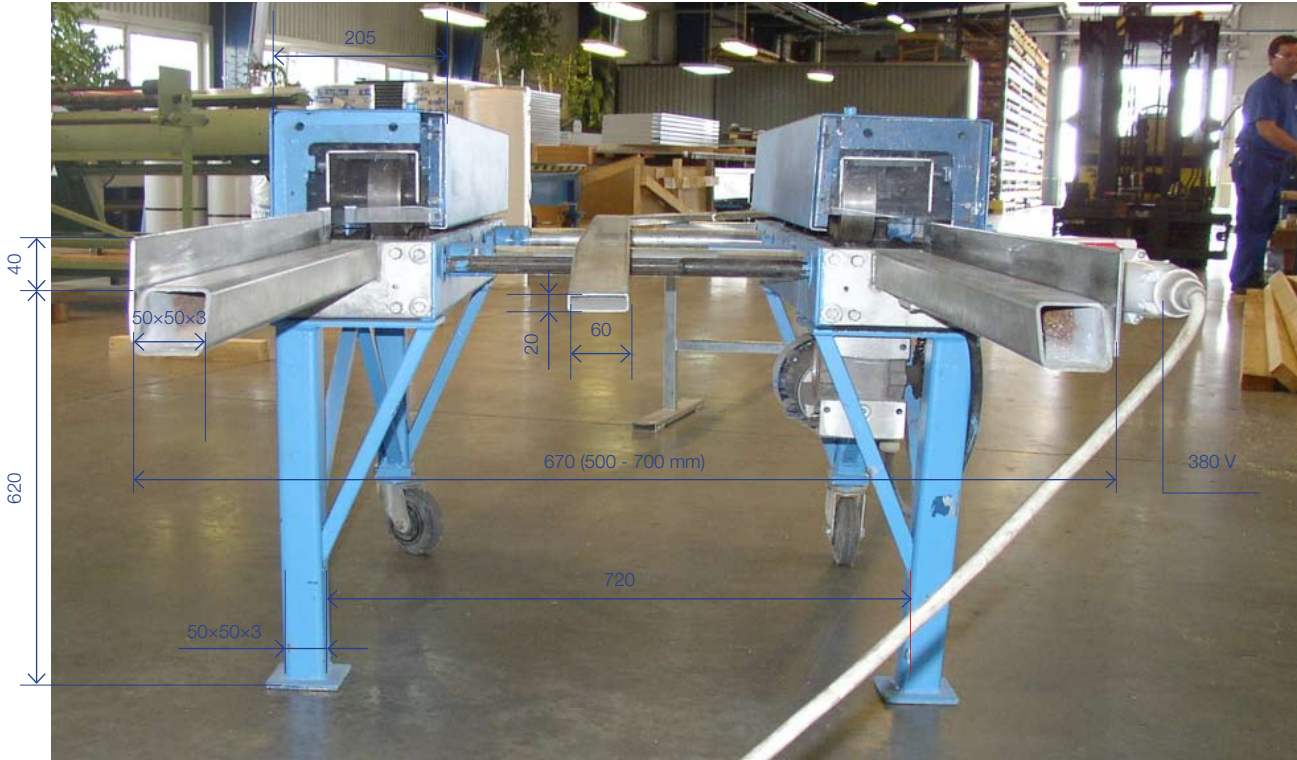
A görgők közti hézagot nagyon precízen kell beállítani! Ez a beállítás határozza meg a hajlítások minőségét.
