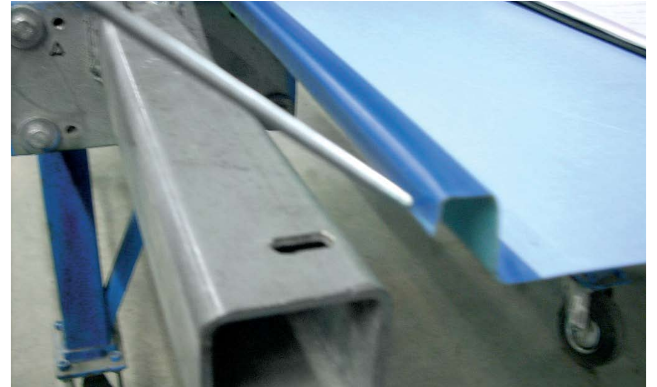
Ebben az esetben a hajlítási paraméterek értéke: 13 és 10 mm (lásd a keresztmetszeti rajzot). A 13 mm fix (ezt a görgők végzik), a 10 mm-t ugyanúgy be lehet állítani ezen az oldalon, ahogy a 9 mm-es peremet beállítjuk a másik oldalon.
