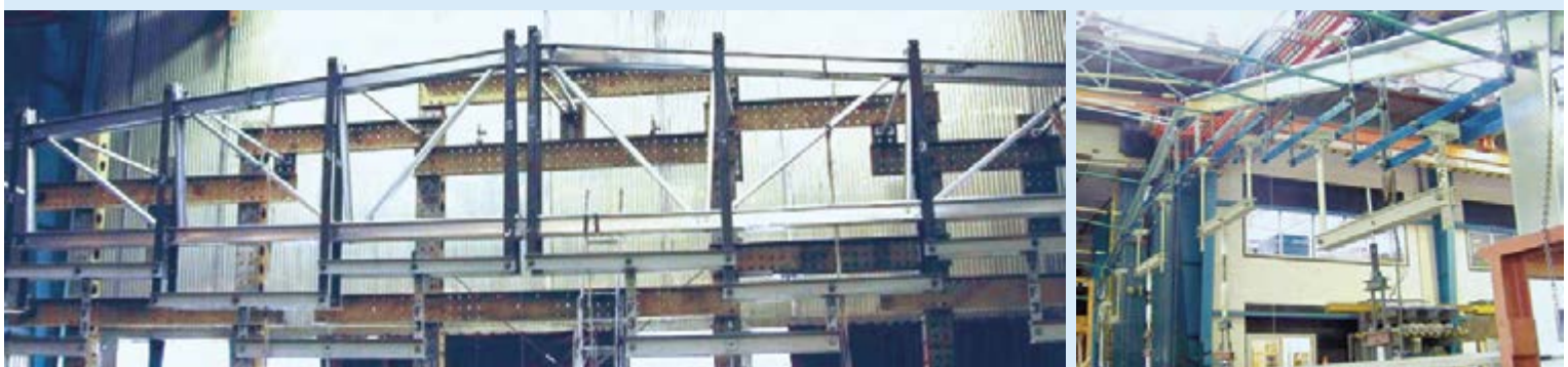
9. ábra A BME-n végzett korábbi Lindab laboratóriumi vizsgálatok (SBS, LindabTruss) eredményei az SBS Maxi szerkezetek teherbírási méretezésében is felhasználásra kerültek.
