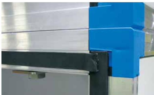
Bild 15: Tätningslisten måste överlappa i hörnen. När två sektioner ska kopplas ihop ska tätningslist bara placeras på den ena sektionen.
