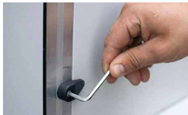
Bild 22: Övertrycksluckor och löstagbara serviceluckor är fästa vid höljet med spärrar. Använd en insexnyckel storlek 4 för att ta bort/sätta fast spärrarna.
