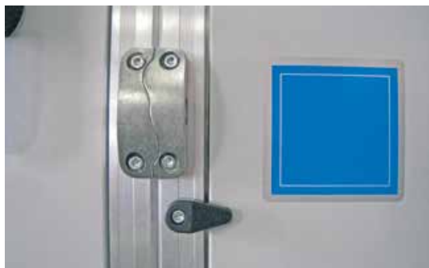
Bild 19: Skjut först ihop sektionerna och sammanfoga dem sedan med excenterklämmor som placeras på ramarna. De excentriska klämmorna sitter på både de vågräta och lodräta sidorna, antingen på insidan (bild 20) eller utsidan (bild 19) av ramen.
