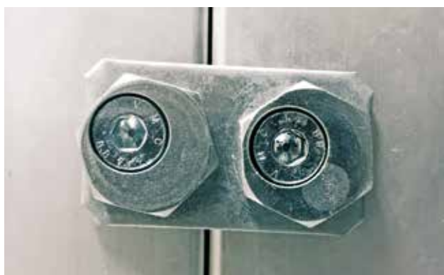
Bild 21: Fäst klämmorna på insidan med särskilda M8x25-excenterskruvar. Skruvar medföljer i ett separat paket.
