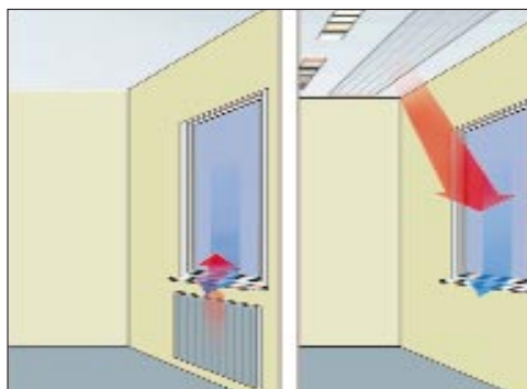
Az ablak felületeinek fűtése révén a mennyezeti fűtőelem kizárja a huzat kockázatát.
