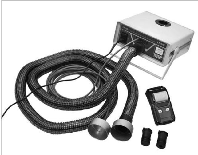
Le leakage Tester est un équipement simple et complet de caractérisation sur site ou en laboratoire de l'étanchéité à l'air des réseaux aérauliques (circulaires et/ou rectangulaires).
