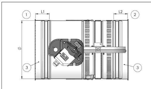
Lunghezza terminale con rete in funzione del diametro Ø della serranda tagliafuoco.
