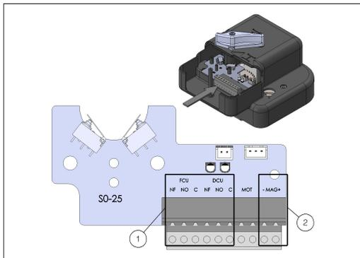
■ Posizione dei microinterruttori di posizione per comando manuale e manuale con magnete
