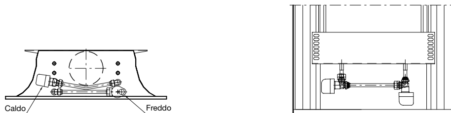
Figura 5. Le valvole e gli attuatori sono posizionati come in figura. Riscaldamento e raffrescamento hanno diametro \varnothing 12 mm.
