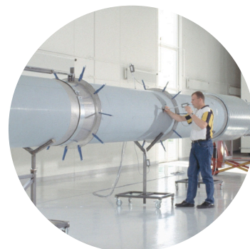
Kaiuttimen ja kaiuntahuoneen välissä on 21 metriä pitkä mittauskanava, jonka kokoa pystytään säätämään mitattavan vaimentimen koon, pituuden ja muodon mukaan. Järjestelmällä pystytään mittaamaan sekä pyöreät-, että suorakaidevaimentimet.
