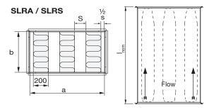
Per calcolare (S) considerato il dato (a) consultare pag. 4 delle istruzioni di montaggio AeroDim SLRA/SLRS.
