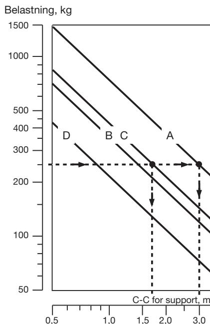
A = udbredt, jævnligt fordelt statisk belastning for rør 45 x 45 x 2,0 mm
