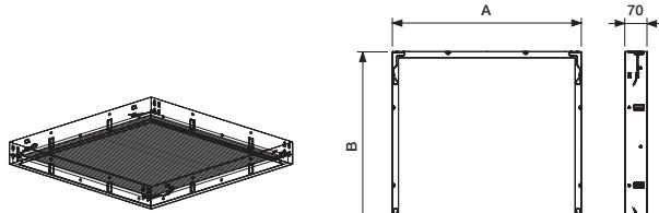
Filtrramme til panelfiltre 44, til V-cellefilter samt posefilter FK. Skruehuller Ø6 mm til sammenkobling af rammer.
