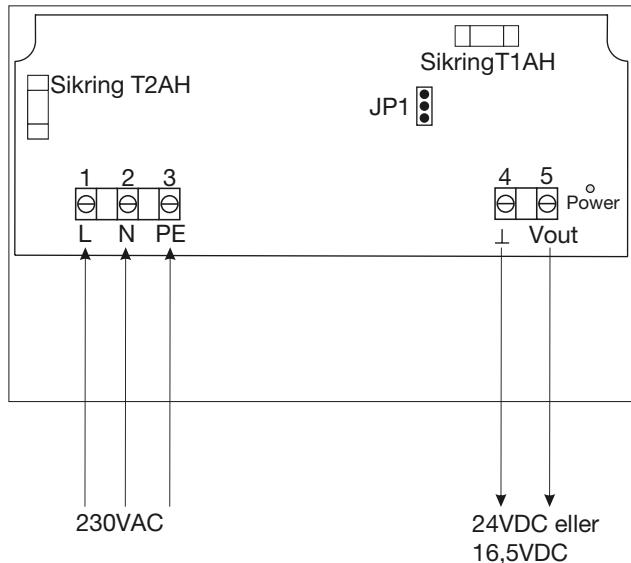
Jumper 1 (JP1) kan indstilles, så udgangsspændingen kan vælges til 24VDC/1A eller 16,5VDC/1A.
