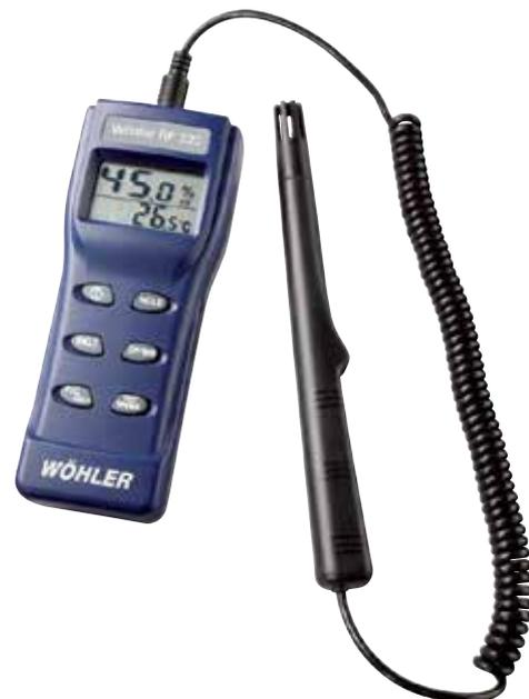
Raumluftfeuchte-Messgerät Hygrotemp RF 220
