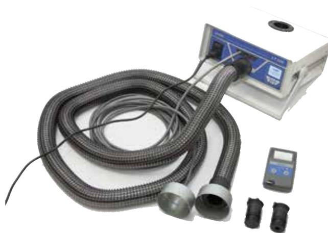
Komplettausrüstung zur Dichtheitsmessung von Luftleitungssystemen vor Ort, im Labor oder im Werk. Vollständig verpackt in zwei handlichen Koffern.
