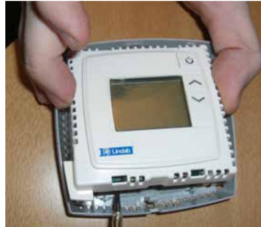
2. Retirer la face avant ainsi que le circuit imprimé.
