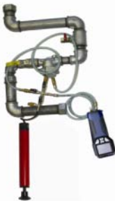
Abb. 53: Anschlüsse bei der Volumenmessung mit Lindab PC 410 und Rußtestpumpe (ab 100 ml Rohrvolumen)
