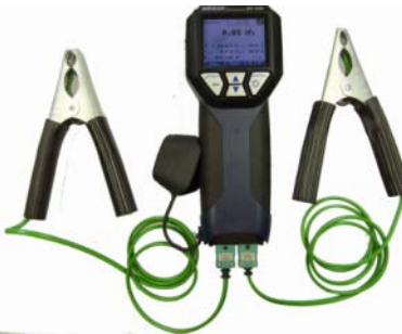
Abb. 4: Anschluss einer Temperaturmesszange
