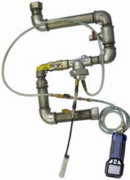
Abb. 52: Anschlüsse bei der Volumenmessung mit Lindab PC 410 und Spritze (bis 100 ml Rohrvolumen)
