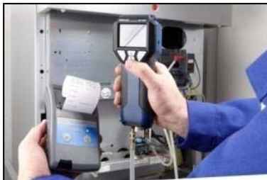
Abb. 59: Übertragung der Messdaten vom PC 410 zum Thermoschnelldrucker TD 100
