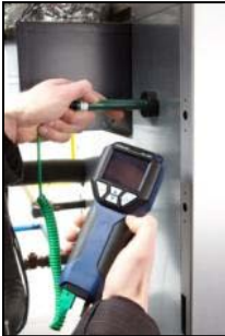
Abb. 56: Anwendungsbeispiel mit Oberflächentemperaturfühler
