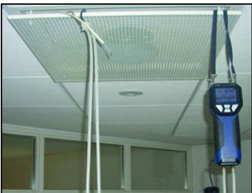
Abb. 20: Anwendungsbeispiel - Befestigung mit Handschlaufe
