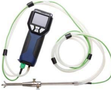
Abb. 33: Anschluss des Stauohrs Typ S an das Lindab PC 410
