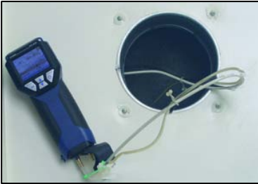
Abb. 18: Anwendungsbeispiel - Anschluss der Messschläuche
