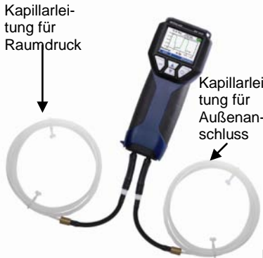
Abb. 36: Lindab PC 410 mit angeschlossenen Kapillarschläuchen
