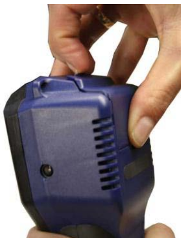
Abb. 10: Öffnen der Batteriefachabdeckung
