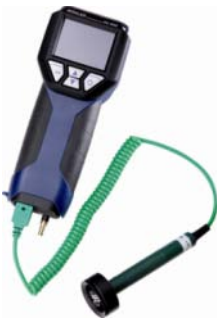
Abb. 5: Anschluss eines Oberflächentemperaturfühlers zur U-Wertmessung
