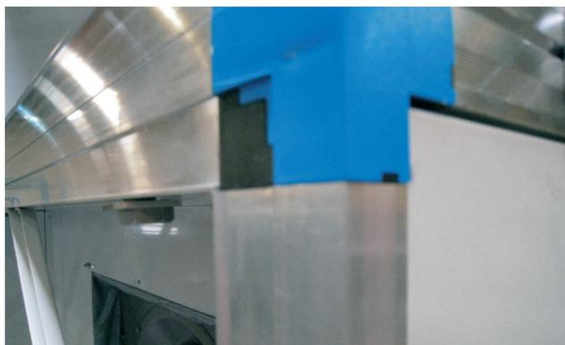
Abb. 14: Bringen Sie selbstklebendes EPDM-Gummidichtband mit einem Querschnitt von 20 x 8 mm (im Lieferumfang des Lüftungsgeräts enthalten) auf die vorderen Kontaktflächen (Gehäuserahmen) auf, wenn Sie die Sektionen mit einem Aluminiumprofil verbinden.
