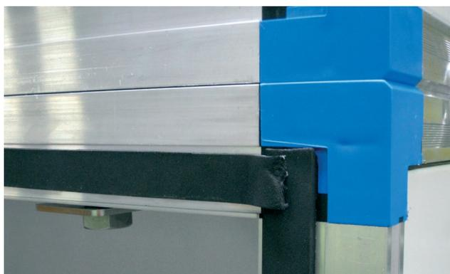
Abb. 15: Das Dichtband muss an den Ecken überlappen. Wenn zwei Gerätesektionen miteinander verbunden werden, muss das Dichtband nur auf einer Sektion angebracht werden.
