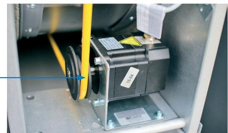
Motor mit Riemenantrieb
