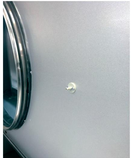
Abb. 50: Schlauchverbinder für die Messung des Kanaldrucks. Der Benutzer muss den beigefügten Schlauch am Verbinder anbringen. Das andere Ende muss am Luftauslasskanal angeschlossen werden. Das gleiche Verfahren ist auf der Einlassseite durchzuführen. Innerhalb von CompAir müssen die Schläuche an den Innenverbindern angeschlossen werden.
