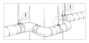
In den Fällen, in denen die Montage gesichert werden muss, z. B. wenn ein Bogen in einer Rohrleitung eingesetzt wurde, der sich nach unten verdreht. Montieren Sie die erste Aufhängung und anschließend den Bogen, sichern Sie die Verbindung anschließend mit einer Schraube oder einer Niete.
