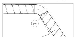
Montieren Sie das nächste Stück der Rohrleitung im entsprechenden Winkel, stellen Sie jedoch sicher, dass die Gummidichtung nicht sichtbar ist. Verwenden Sie an den Stellen Schrauben oder Nieten, an denen die Nocken nicht eingerastet sind.
