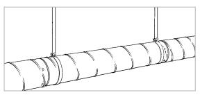
Montieren Sie die Aufhängungen in einer geraden Linie und so nahe wie möglich an den Verbindungen. Verwenden Sie zusätzlich eine Schraube, um eine besonders stabile Verbindung zu erhalten.
