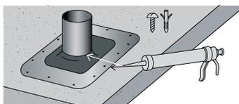
Die Membrandurchführung ankleben und evtl. anschrauben auf der Rohdecke, vor weiterem Bodenaufbau.
