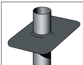
4. Membrandurchführung an Anschlußbauteil ankleben oder schrauben und dichten.
