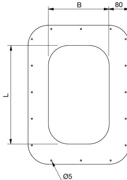
Spezielle Abmessung, einsetzbar für 0°-Neigung und Rohre von Ø100 - Ø160
