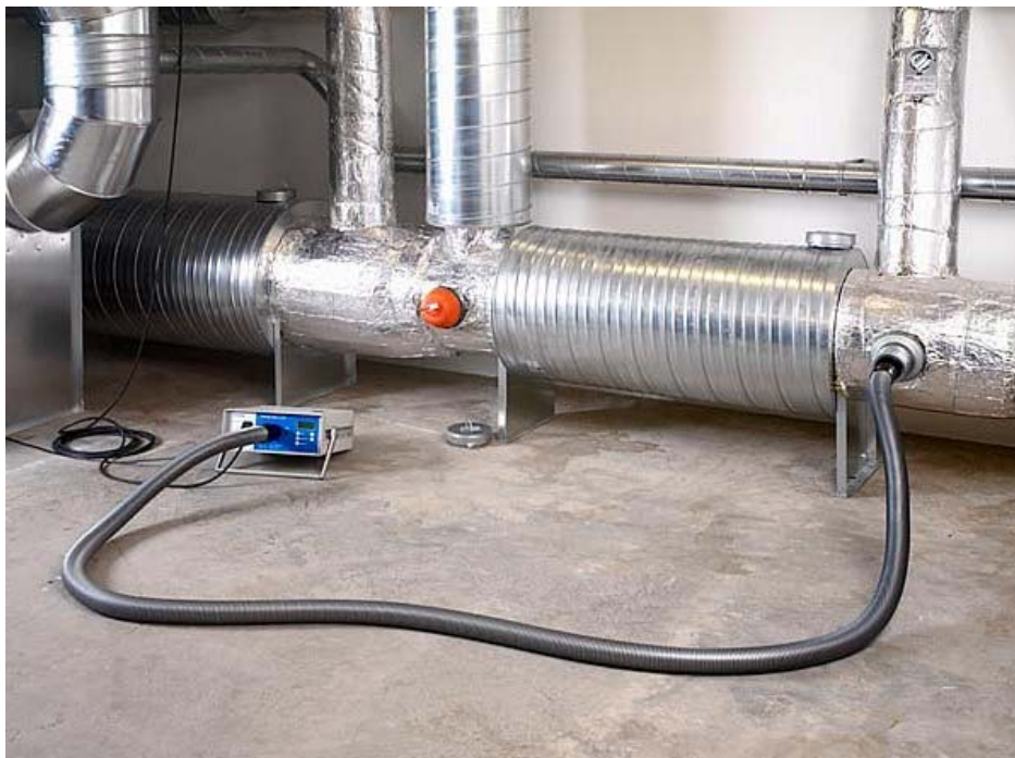
Bild 3 : Verbindung zum Luftleitungssystem
