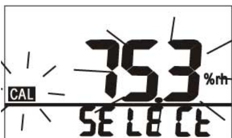
Abb. 28: Kalibrierung des Luftfeuchtigkeitssensors
