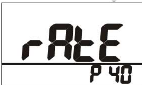
Abb. 21: Setup – Einstellen der Lograte
