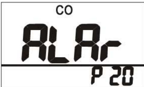
Afb. 19: Setup - Instellen van de CO-alarmdrempel
