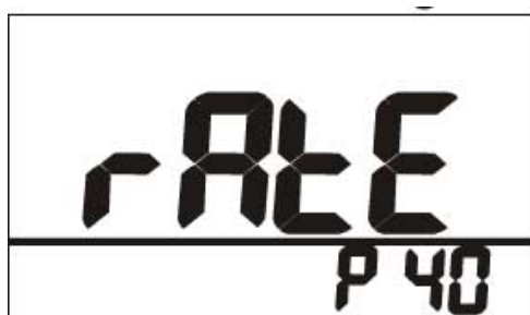
Afb. 21: Setup – Instellen van de lograte
