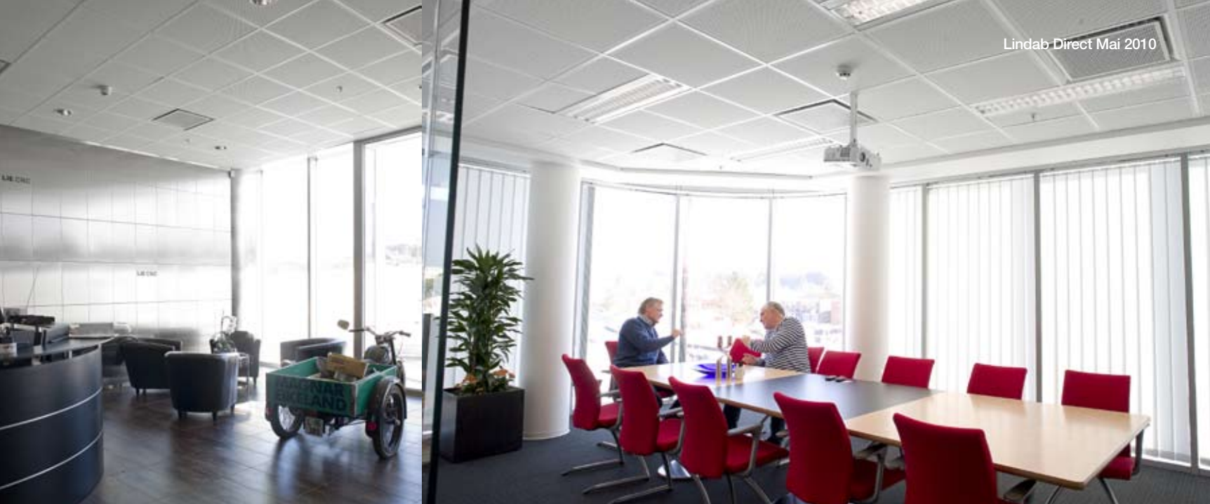
In DNFs neuen Büroräumlichkeiten in Sandnes sitzen rund 90 Plexus Kühlbalken. In der Kombination mit einer Wärmepumpenanlage ergibt sich eine sehr hohe Energieeffizienzklasse nach dem neuen norwegischen Klassifizierungssystem. Ganz ohne Radiatoren sind luftige, offene Räume entstanden.
