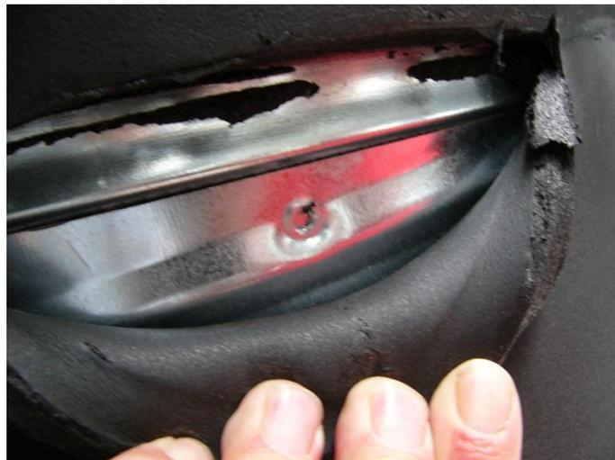
Bild 5: Unverschlossene Schrauben oder Nietlöcher
