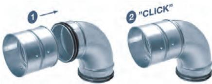
Abbildung 6: Selbstsicherndes Rohrsystem in Dichtheitsklasse D für den Nennweitenbereich 80 bis 315.
