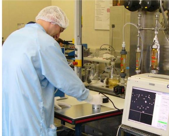
Reinigbarkeitsuntersuchung mit dem Meßgerät ParticleGuard
