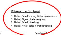
Die vier Reihen auf der rechten Seite haben eine besondere Bedeutung. Sie werden verwendet, um mithilfe der berechneten Werte zur Schallerzeugung, Schallminderung und benötigten Schallminderung den für den Raum benötigten Schallpegel zu erhalten (siehe auch bei [Ventilation - Comfort Express](#)).
