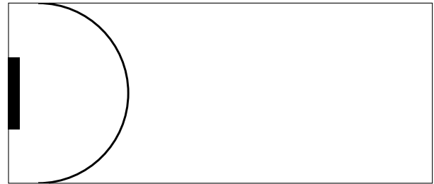
Abb. 9: zu starke Luftströmung aus einem Auslass führt zu einem zu großen Nahbereich
