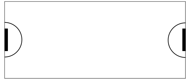
Abb. 10: geringer Volumenstrom pro Auslass, kleiner Nahbereich
