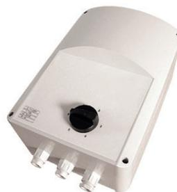
Trasformatore per motori AC monofase a 5 stadi, con posizione 0. Regolazione con interruttore frontale. Indicatore luminoso di funzionamento sull'alloggiamento. Il controller è racchiuso in un alloggiamento in PVC, ad eccezione del mod. VRTE 13 che è in acciaio.
